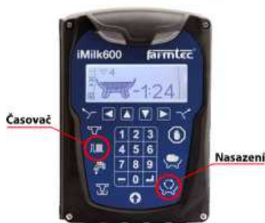
Obrázek: iMILK600 s vyznačením tlačítka na klávesnici pro spuštění časovače a nasazení po uplynutí ideální doby přípravy vemene.
