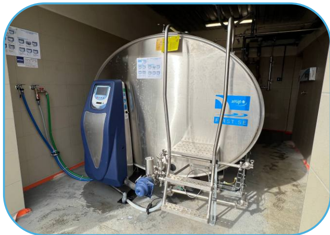
tank s přímým chlazením o objemu 5 200 litrů
