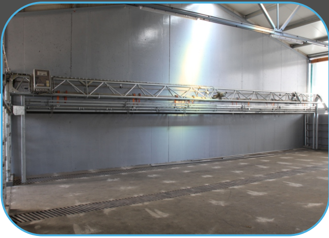
přiháněč dojnic se shrnováním kejdy, šířka 13,8 m
