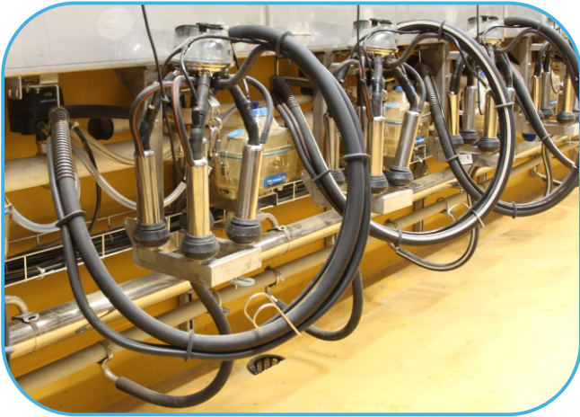
dojící stroj se systémem AirWash
