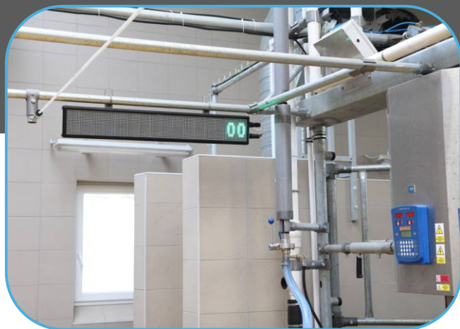
info panel v jámě dojice ukazuje nastupující krávy
