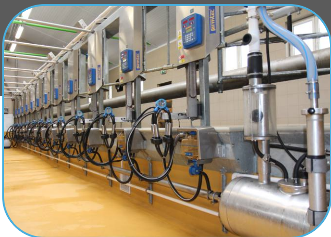
rybinová dojírna s polohovatelnými rameny dojícího stroje
