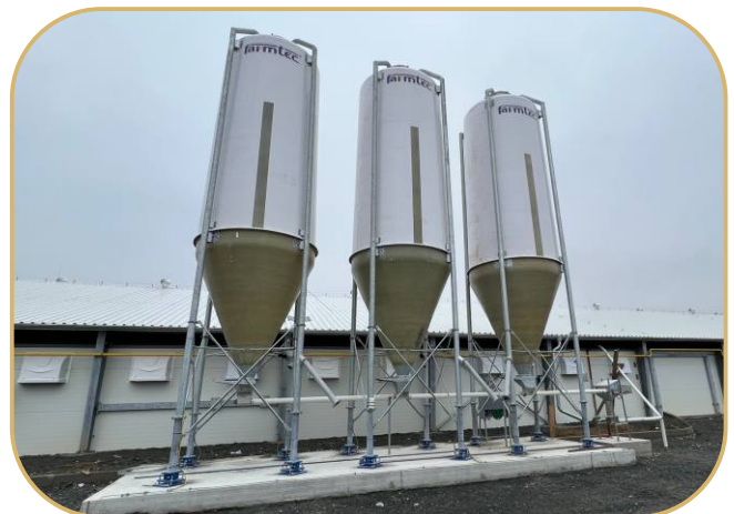
zásobníky krmiva umístěné na tenzometrických vahách
