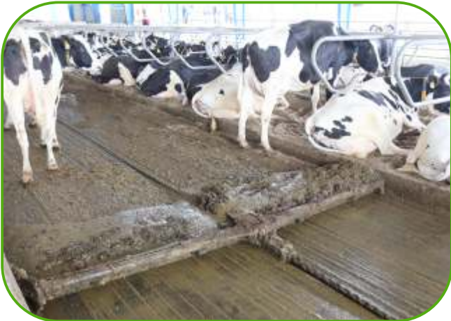
skládací shrnovací řetězová lopata - systém DELTA II
