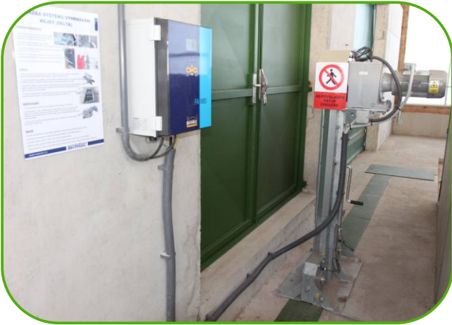
pohonná jednotka pro vyhrnování kejdy - systém Delta
