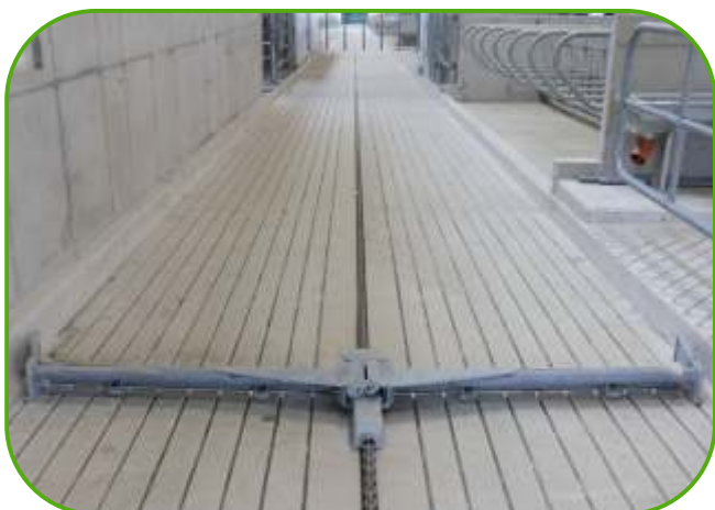
skládací shrnovací řetězová lopata - systém DELTA II
