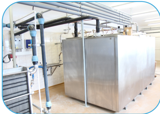
dvoustupňový předchladič s rekuperací
