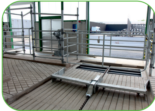
řetězový systém vyhrnování výkalů Delta
