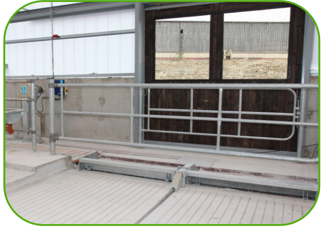
systém DELTA - fetězová shrnovací lopata a pohonná jednotka
