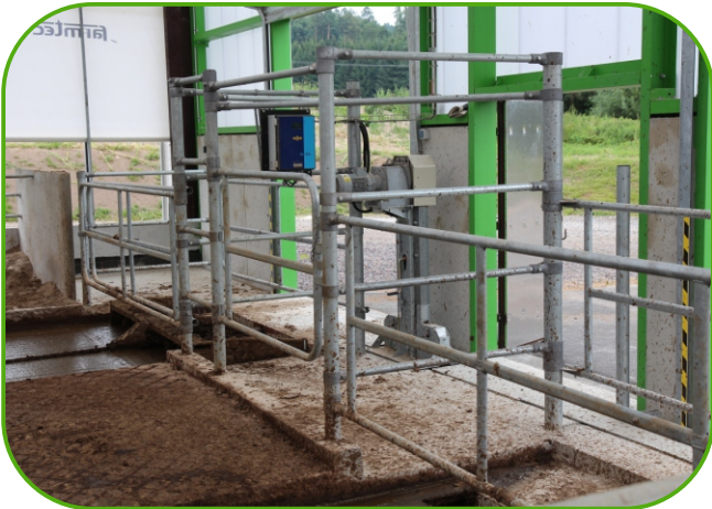
pohonná jednotka DELTA s ovládacím panelem
