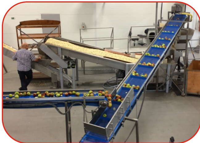
doprava do drtiče
