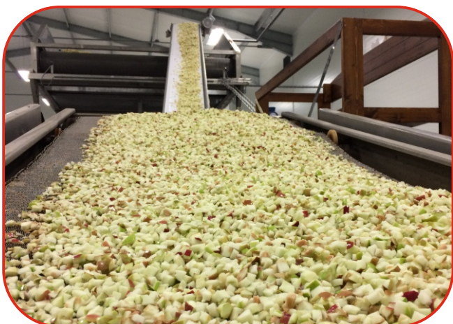
dopravník z drtiče do sušárny
