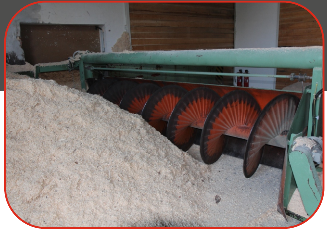
podávací šnek vstupního dopravníku
