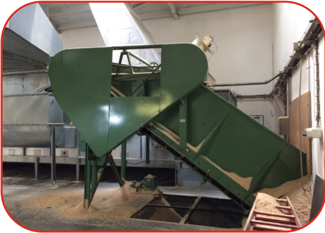
vstupní dopravník pilin do sušárny
