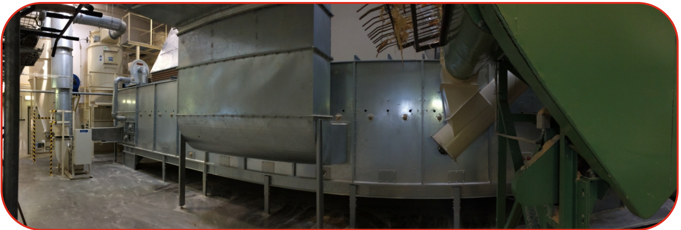
pohled na sušárnu s navazující technologií peletování
