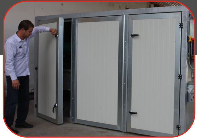
koncová část sušárny, veškeré panely na sušárně lze otvírat
